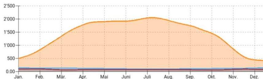
Abbildung 203: Hauptstrasse 21a, Monatliche Stromproduktion der PV-Anlage in kWh für ein typisches Jahr
