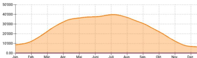
Abbildung 13: Ygrubenstrasse 17, Monatliche Stromproduktion der PV-Anlage in kWh für ein typisches Jahr
