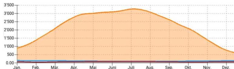
Abbildung 36: Landstrasse 42, Monatliche Stromproduktion der PV-Anlage in kWh für ein typisches Jahr
