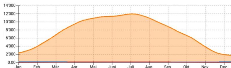
Abbildung 30: Schwimmbadstrasse 1, Monatliche Stromproduktion der PV-Anlage in kWh für ein typisches Jahr
